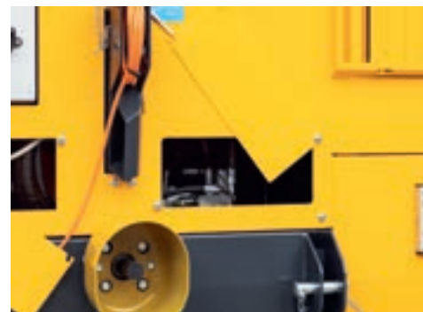
Trappes pour un nettoyage plus facile de la machine
