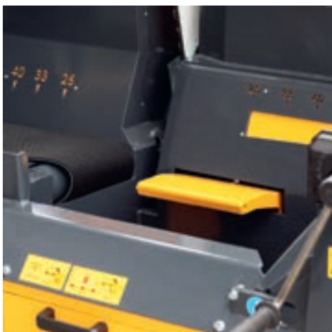
Le volet de retenue empêche les bûches de basculer dans le canal de fendage
