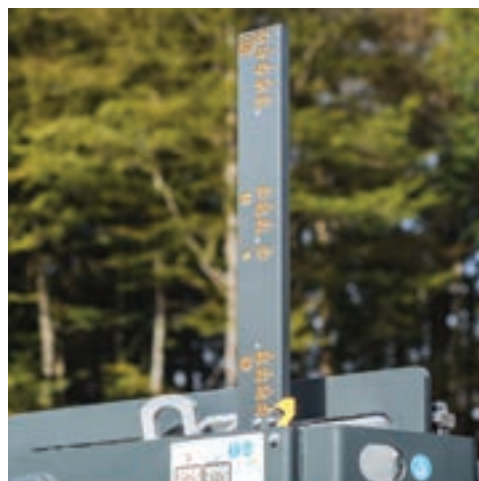
Coin de fendage multiniveaux 2-4-8-18, réglable hydrauliquement
