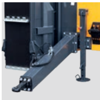
Le crochet d'attelage peut être monté à deux hauteurs différentes : 340 mm et 800 mm.
