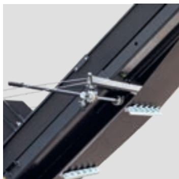
Mécanisme d'extension et de repli du tapis convoyeur
