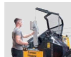
Mécanisme de levage du coin de fendage
