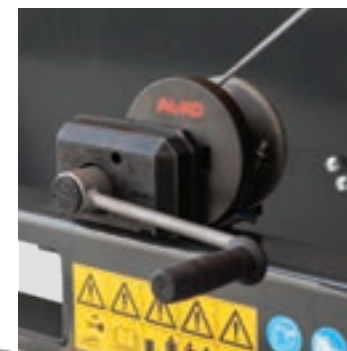
Treuil manuel permettant de régler l'inclinaison de la bande de 0° à 40°.
