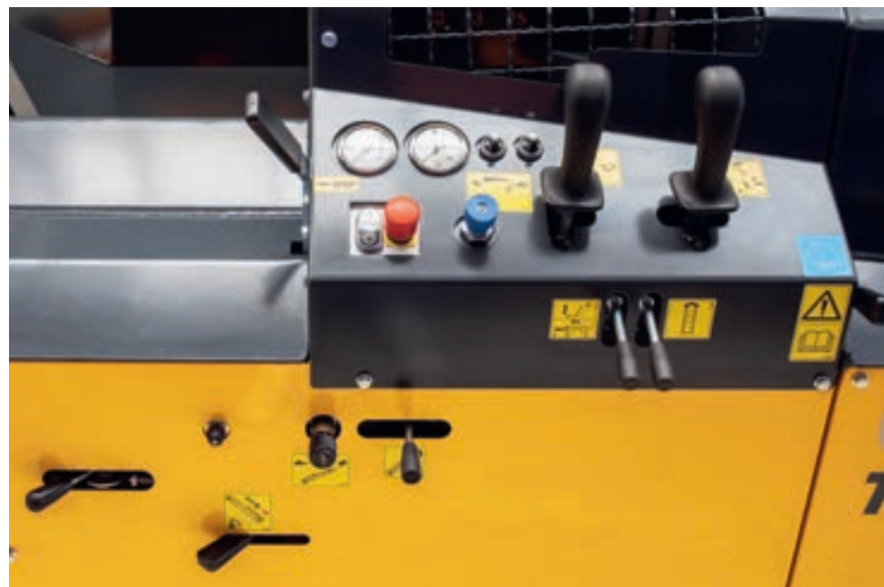
Commande hydraulique avec leviers ergonomiques
