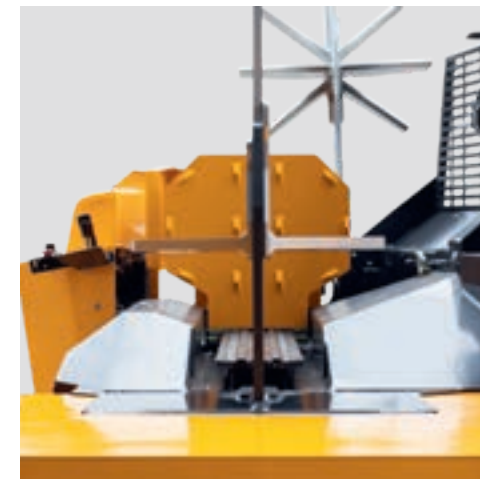
Coin de fendage 2/4, 2/6 et 2/8 éclats avec levage hydraulique
