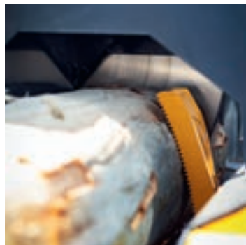
Une pince hydraulique pour stabiliser la grume.
