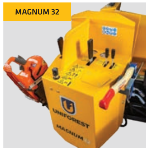
Des compartiments de rangement pour les accessoires sont placés à portée de main. Équipée de supports intégrés pour hache, petite et grande pioche, et également compatible avec les tronçonneuses.
