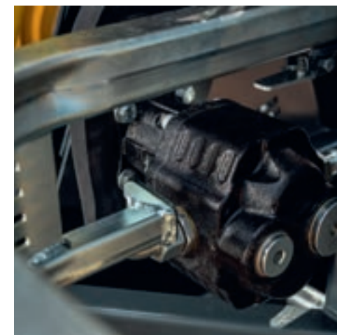
La pompe à engrenages à deux vitesses garantit une faible consommation d'énergie pour les motorisations électriques et prise de force + électrique. (De série sur les modèles TITANIUM 23 et 27, en option sur le modèle 18.)
