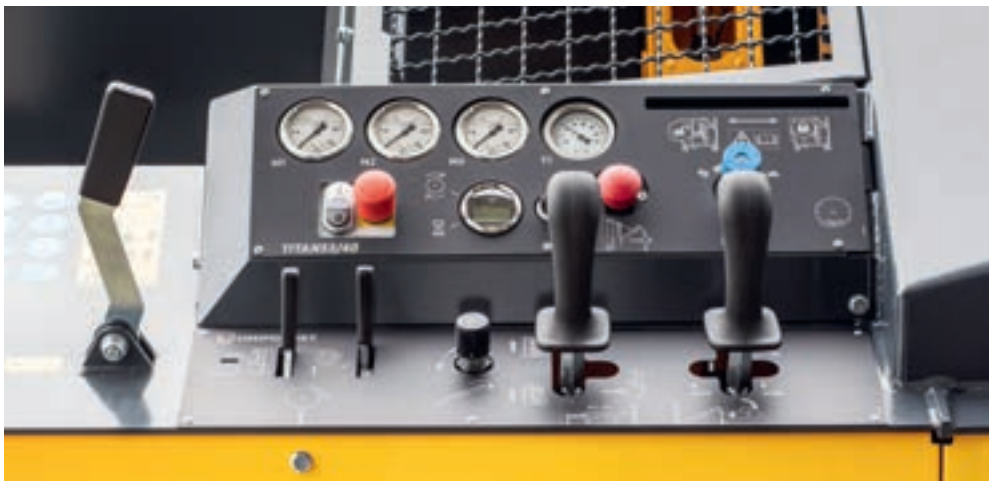
Fonctionnement mécanique avec poignées réparties de façon ergonomique
