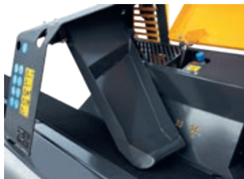
La pince hydraulique maintient la grume pendant la coupe
