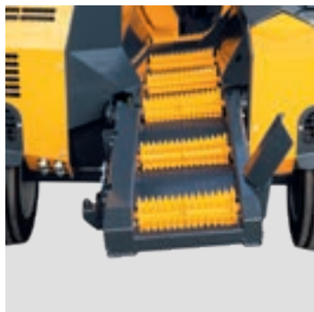
Entraînement hydraulique des rouleaux du tapis ameneur.
