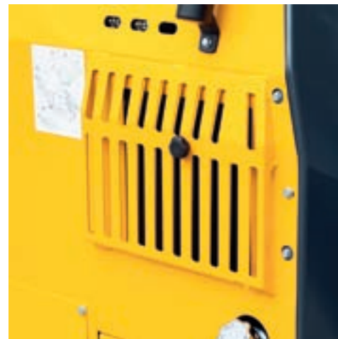
Protection pour le refroidisseur d'huile
