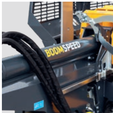
BOOMSPEED – Toutes nos fendeuses horizontales sont équipées en standard de la fonction BoomSpeed, qui raccourcit le cycle de fendage jusqu'à 50 %.
