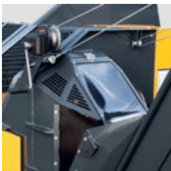
Inclinaison à l'aide d'un treuil mécaniquement réglable.
