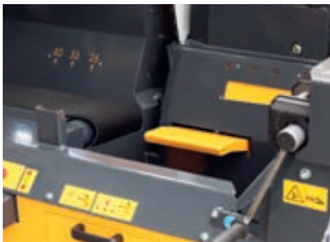
Le volet de retenue empêche les bûches de basculer dans le canal de fendage
