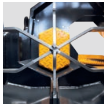
Coin de fendage 2-4, 2-6, 2-8 ou 2-12 – réglables hydrauliquement en hauteur.
