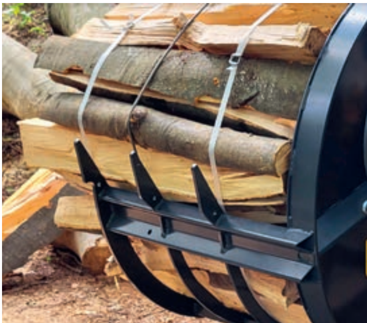
Rouleaux pour un basculement plus facile
