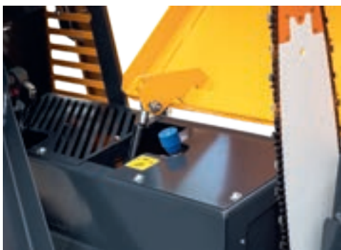
Accélérateur pour régler la vitesse de coupe de la lame
