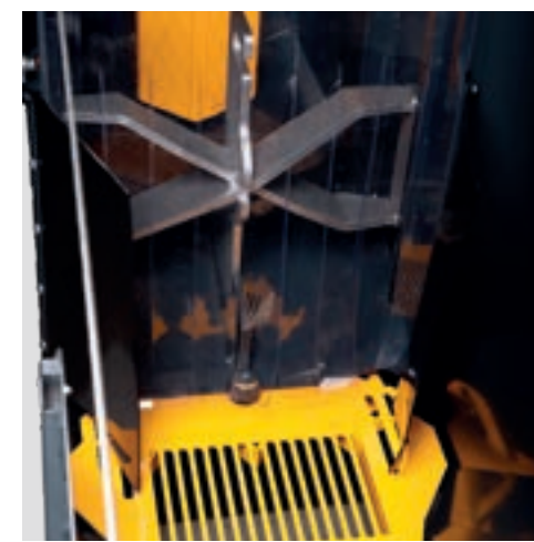
Sépare les petits morceaux issus de la coupe et du fendage.
