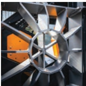
Coin de fendage multiniveaux réglable hydrauliquement
