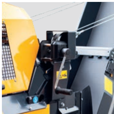
Inclinaison à l'aide d'un treuil mécaniquement réglable.
