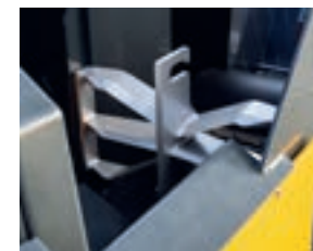
Réglage automatique de la hauteur du coin de fendage en fonction du diamètre de la bûche
