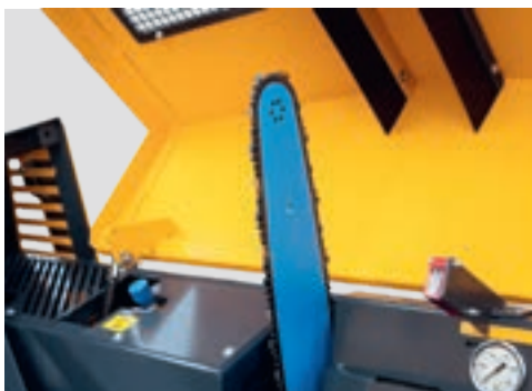
Guide chaîne type tête d'abattage résistante et solide.
