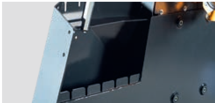
Les compartiments à chaîne sont partiellement ouverts sur le dessus, facilitant ainsi le rangement de la chaîne forestière.
