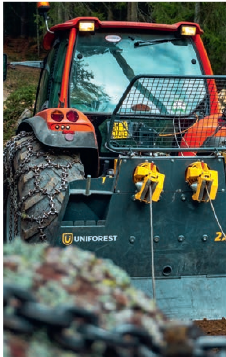
Les compartiments à chaîne sont partiellement ouverts sur le dessus, facilitant ainsi le rangement de la chaîne forestière.
