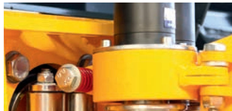
Le dérouleur de câble, équipé de deux cylindres de pression et de deux moteurs hydrauliques, permet d'obtenir une tension plus élevée du câble entre le dérouleur et le tambour, garantissant ainsi une force de déroulement accrue.
