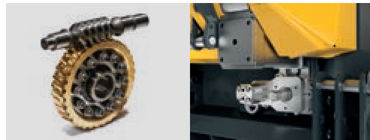
La motorisation repose sur un entraînement par vis sans fin, permettant d'importantes variations de vitesse et une excellente résistance aux charges brusques. Le système comprend également des engrenages entièrement immergés dans un bain d'huile, garantissant un meilleur rendement, un entretien réduit et une durée de vie prolongée. La vis sans fin est fabriquée en alliage d'acier de haute qualité, traité, cémenté et poli pour une performance optimale. La roue de vis sans fin, quant à elle, est réalisée en bronze spécial, offrant une résistance accrue à l'usure et une fiabilité durable.
