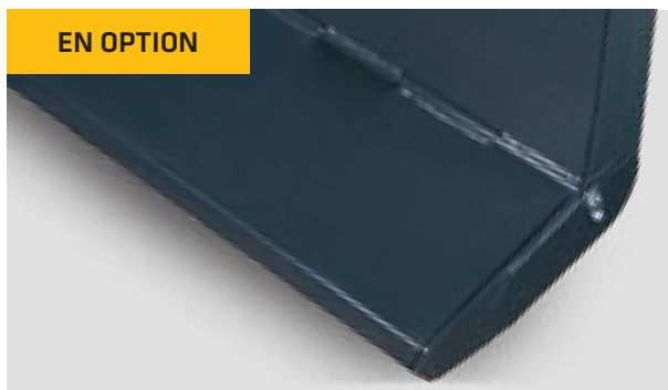
Le tablier articulé hydrauliquement, grâce à son centre de gravité plus bas, permet une manipulation plus aisée du bois et un empilage simplifié des grumes.
