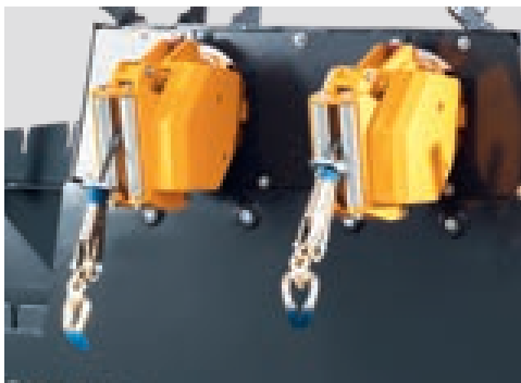
Systèmes hydrauliques séparés pour les tambours et les sorties de câble
