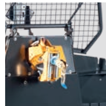
Dispositif de déroulement équipé d'un moteur hydraulique haute performance
